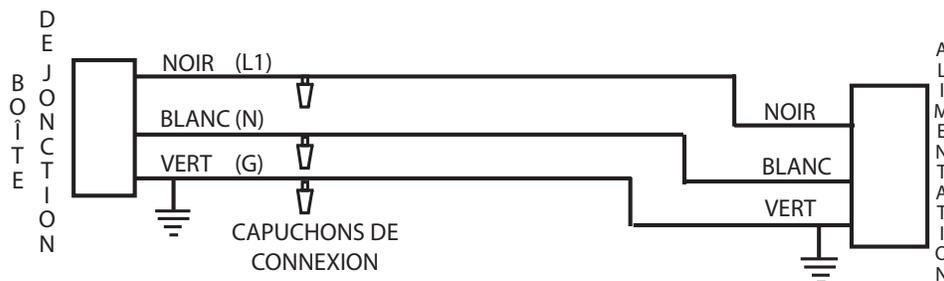
**NOTE: Pour vous aider avec le déplacement de l'appareil, laissez une longueur de fils suffisante pour que l'appareil puisse être retiré de l'enceinte sans le débrancher du circuit d'alimentation. Si la maintenance, fermer son alimentation électrique.**
